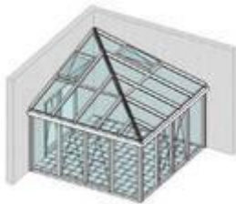
Pulldach mittig diagonal mit Gratsparren, Dachflächen nach außen abfallend
