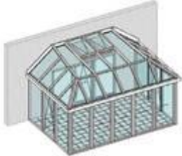
Pulldach mit Solarknick und seitlicher Abwalmung
